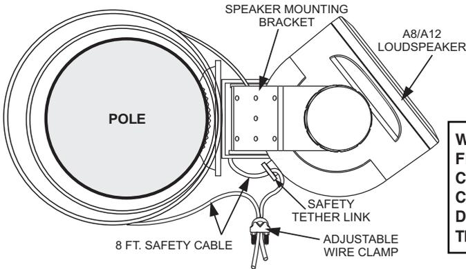
**WHEN INSTALLATION IS FINISHED, THE SAFETY CABLE SHOULD BE TAUT. CABLE SLACK SHOWN IN DRAWING IS FOR ILLUSTRATIVE PURPOSES ONLY.**
