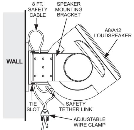
**WHEN INSTALLATION IS FINISHED, THE SAFETY CABLE SHOULD BE TAUT. CABLE SLACK SHOWN IN DRAWING IS FOR ILLUSTRATIVE PURPOSES ONLY.**
